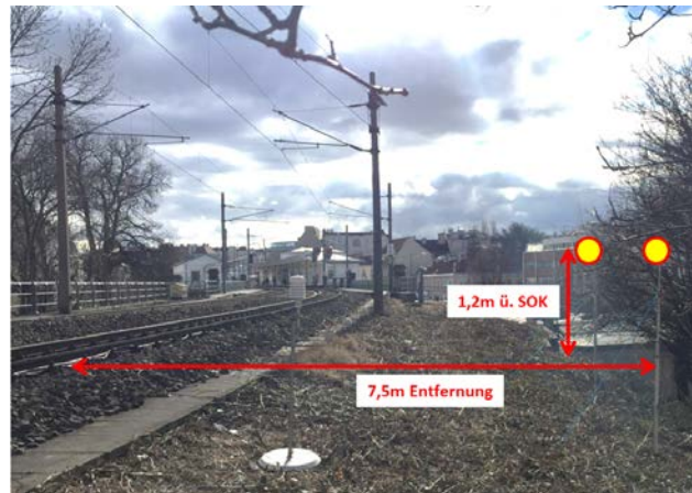
Abb. 3-4: Messquerschnitt MQ1 - Streckeneigenschaften (links) und Übersicht (rechts)
