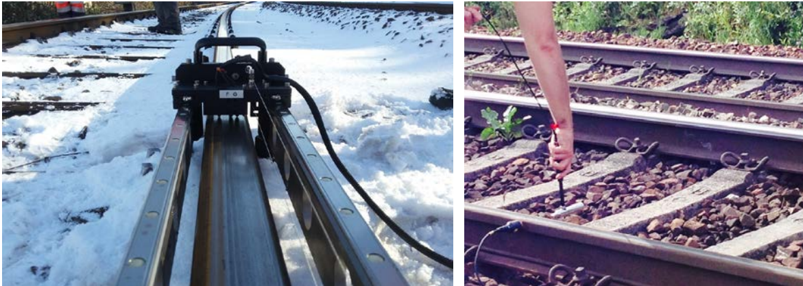
Abb. 3-3: Schienenrauheitsmessgerät ODS TRM-05 (links) und Messung der Schienenabklingrate mittels Impulshammermethode (rechts)
